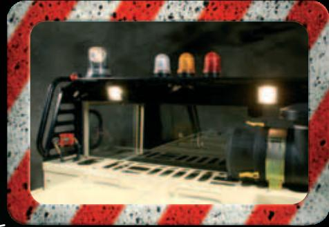
Оснащенность световыми приборами обеспечивает превосходную видимость. Кроме галогеновых или ксеноновых фар головного света на дополнительной световой консоли могут монтироваться фара-искатель с дистанционным радиоуправлением, проблесковый маячок, стробоскоп, повторители указателей поворота, габаритных огней и стоп-сигналов.
