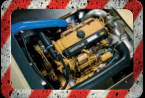
Мощности и крутящего момента с запасом: Машина оснащается дизельными двигателями DEUTZ BF4M2012C мощностью 95 кВт (129 л.с.) или CAT 3054E DITAAC мощностью 97 кВт (132 л.с.)
